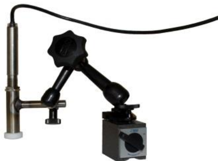
III. 2: Infrarød sensor med magnetfod og emissionsklæber til måling af temperatur på skinnende overflader
