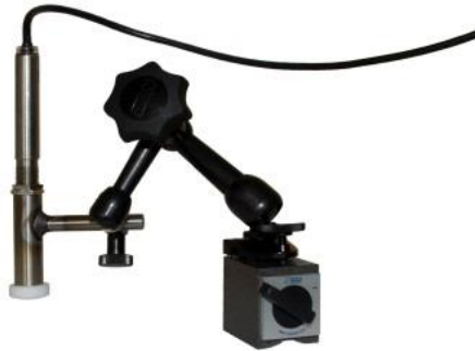
Obr. 2: Infračervený senzor s magnetickou patkou a lepící páskou pro zvýšení emisivity pro měření teploty lesklých povrchů
