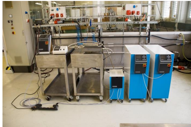
Фиг. 1. Пример за инсталирана система Vario-5 (примерна конструкция с тестов инструмент и симулатор на машината)
