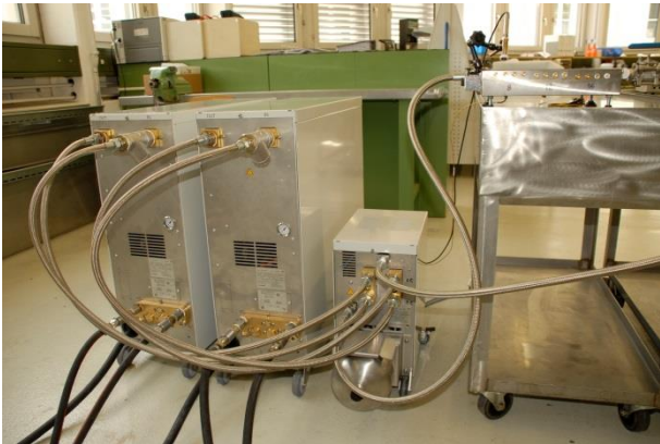
Фиг. 1. Пример за инсталирана система Vario-5 (примерна конструкция с тестов инструмент и симулатор на машината)
