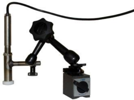
Фиг. 2: Инфрачервен сензор с магнитно краче и стикер за емисиите за измерване на температурата на гланцирани повърхности
