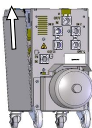
Obr. 63: Vytiahnutie bočného plechu
