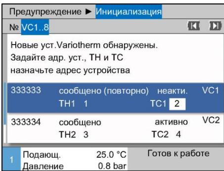
Рис. 25: Назначение адреса ТС
