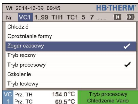
Rys. 50: Włączenie lub wyłączenie zegara czasowego
