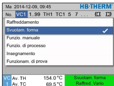
Fig. 43: Attivazione dello svuotamento della forma
