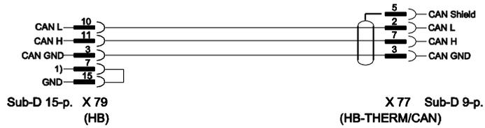
1) Une résistance terminale automatique est montée via ce contact.
