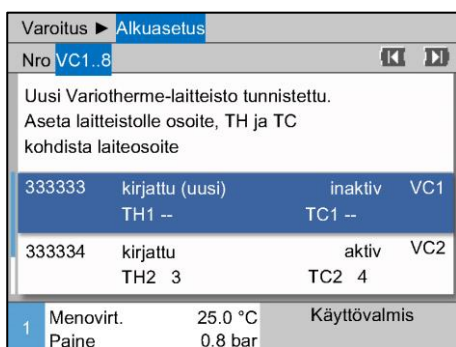
Kuva 22: Uusi laitteisto tunnistettu
