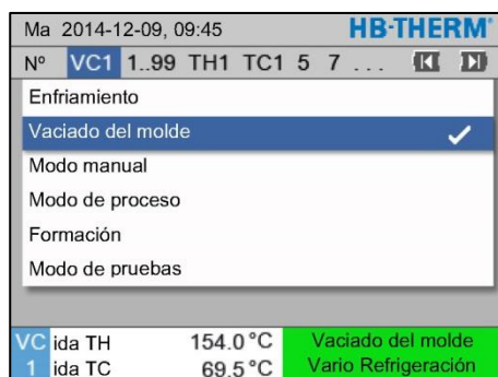
Fig. 43: Activar vaciado de molde
