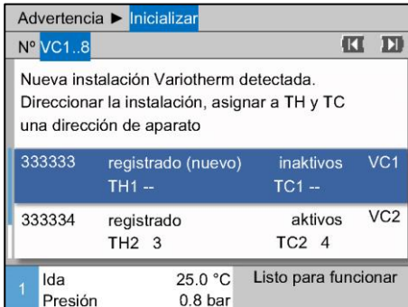
Fig. 22: Nueva instalación detectada
