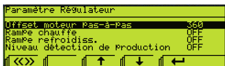
Fig. 5 : Réglage de l'offset du moteur pas à pas
