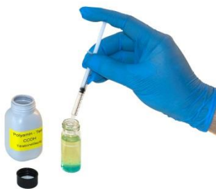
Fig. 15: Add titration solution
