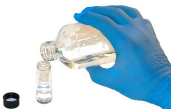
Fig. 9: Fill up the titration glass
