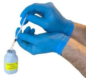
Abb. 14: Messpipette auffüllen
