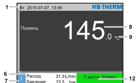
Рис. 20: Основное поле индикации, управление устройством как модулем
