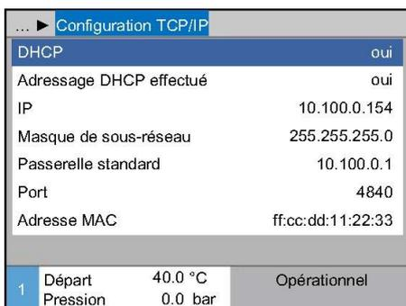
Fig. 37: Paramètres réseau
