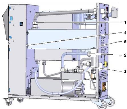
Fig. 73 : Dépose du chauffage
