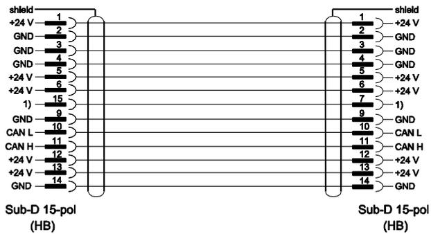
1) Une résistance terminale automatique est montée via ce contact.
