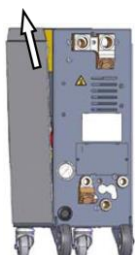
Rys. 72: Wyciągnięcie bocznej osłony blaszanej
