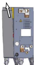
図72：サイドプレートを引き抜きます。
