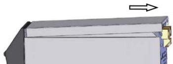
図70：カバープレートを取り外します。
