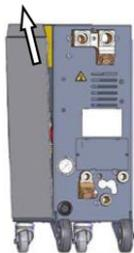
Abb. 76: Seitenblech herausziehen
