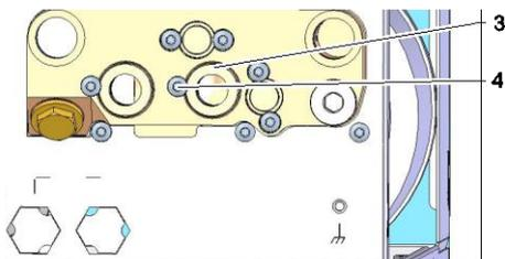
Abb. 11: Separater Anschluss Kühl- und Systemwasserausgang
