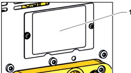
Abb. 81: Abdeckung Ventile
