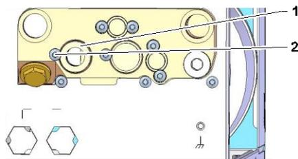
Abb. 10: Separater Anschluss Kühl- und Systemwassereingang
