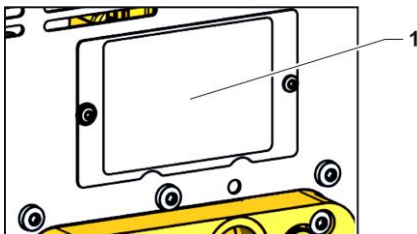
Fig. 81: Afdækning til ventiler
