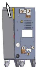
Фиг. 76: Изваждане на страничния панел
