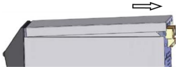
Bild 51: Ta bort täckplåten
