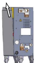
Rys. 53: Wyjąć blachę boczną
