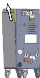
図53：サイドプレートを引き抜きます。
