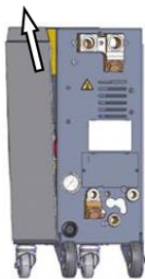
Fig. 53: Estrazione della lamiera laterale
