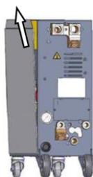
図49：サイドプレートを引き抜きます。
