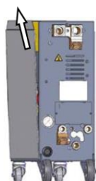
Fig. 49: Extraer la chapa lateral
