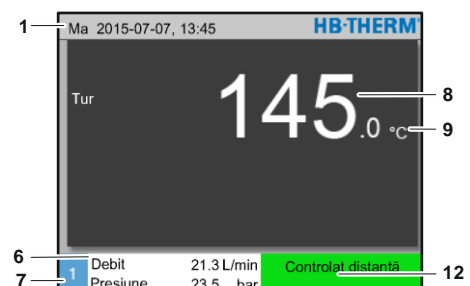
Fig. 21: Afișajul implicit aparat controlat ca modul
