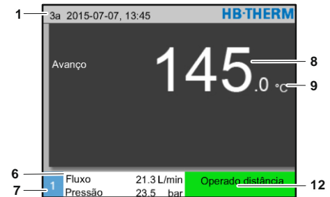
Fig. 22: Indicação básica aparelho operado como módulo
