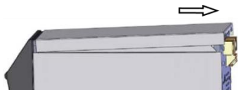
図70：カバープレートを取り外します。
