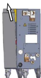
Fig. 73: Tragerea spre afară a tablei laterale
