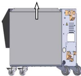
Fig. 72: Tirare verso l'alto la lamiera laterale
