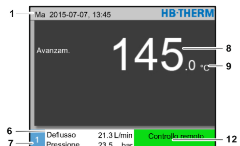
Fig. 23: Visualizzazione di base dell'apparecchio funzionante come modulo
