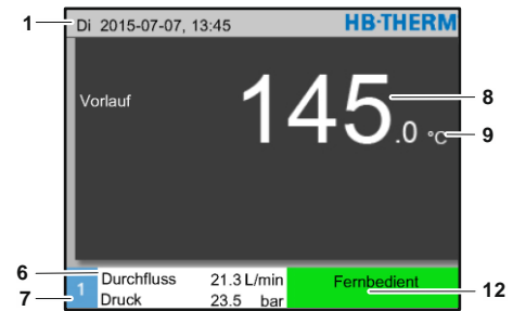
Abb. 23: Grundanzeige Gerät als Modul bedient
