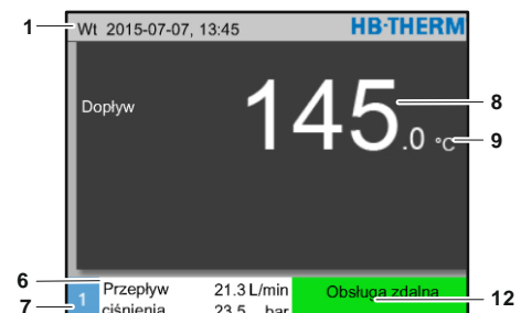
Rys. 22: Ekran główny – Obsługa urządzenia jako moduł
