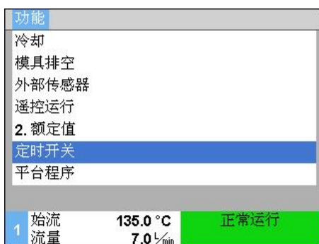
图52：开启和关闭定时开关
