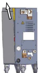
Fig. 72: Tragerea spre afară a tablei laterale
