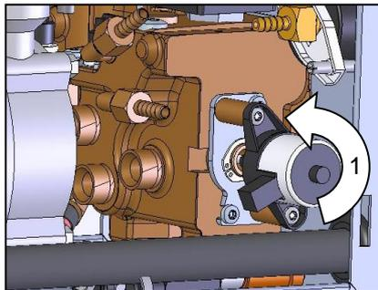
Fig. 76: Desmonte a válvula de refrigeração 1
