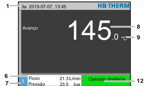
Fig. 20: Indicação básica aparelho operado como módulo
