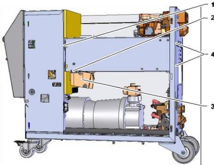
Fig. 75: Desmontar aquecedor
