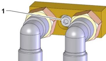
Fig. 10: Fixação central
