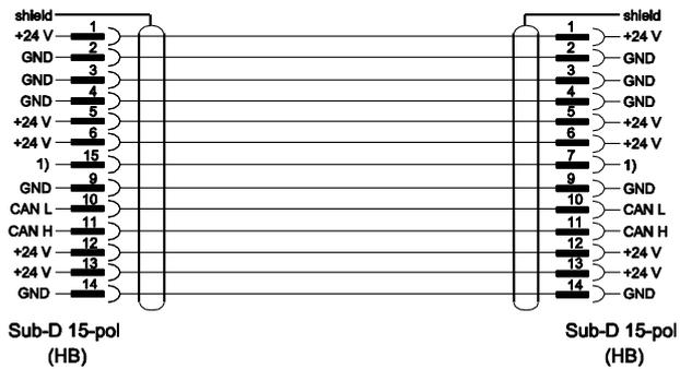
1) Através deste contacto, é ligada uma resistência automática de terminação.
