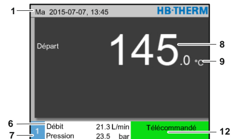
Fig. 20: Premier niveau d'affichage Appareil piloté comme module
