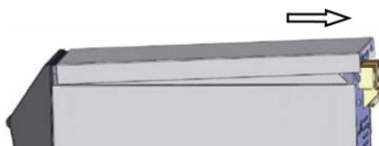
Фиг. 70: Сваляне на ламаринения капак
