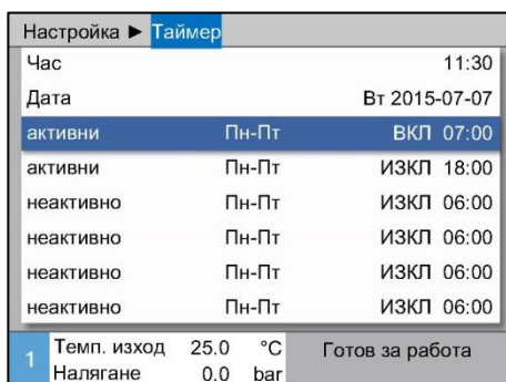
Фиг. 53: Настройки на таймер
