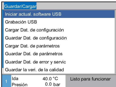
Fig. 57: Iniciar actualización de software
