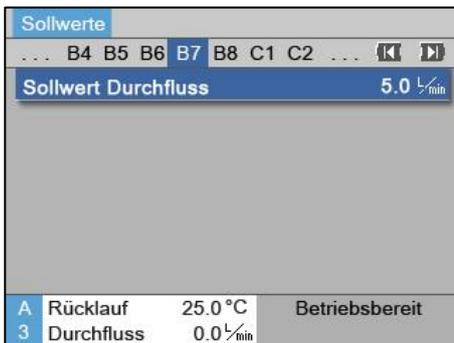
Abb. 45: Bsp. Sollwert Durchfluss B7
