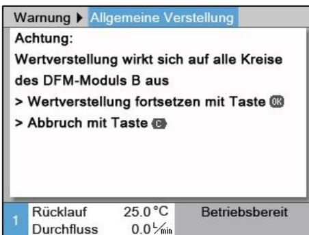
Abb. 41: Wertverstellung DFM-Modul B
