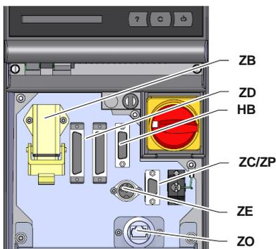
Fig. 17: Interfacce apparecchio singolo
