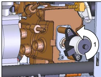
Fig.78 Smontaggio valvola di raffreddamento 1
