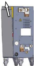
Fig. 74: Estrazione della lamiera laterale
