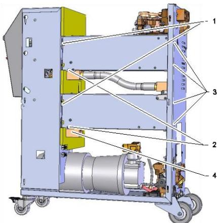
Fig.77 Smontaggio riscaldamento
