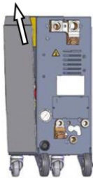
Fig. 74: Retirer la plaque latérale
