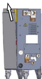
Рис. 77: Боковую панель вытащить
