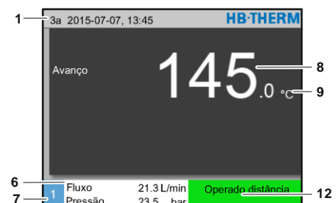
Fig. 24: Indicação básica aparelho operado como módulo
