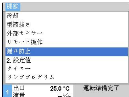
図. 35: 漏れ防止運転をオンにする。
