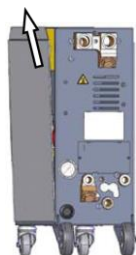
Rys. 74: Wyjąć blachę boczną
