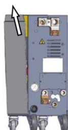
III. 74: Træk sidepladen ud
