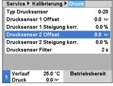
Abb. 2: Drucksensor 2 kalibrieren
