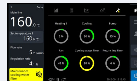
Display do intervalo de manutenção
