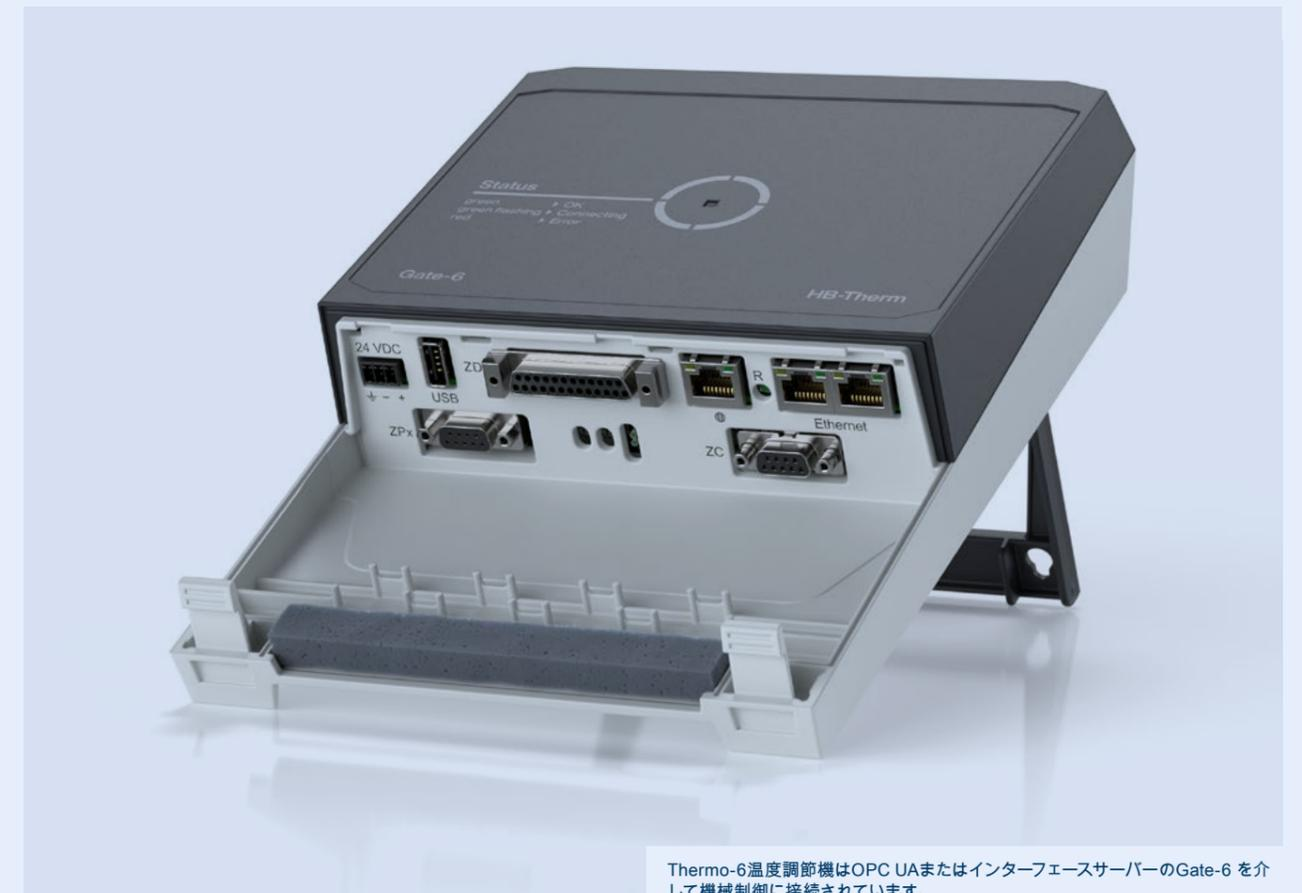
Thermo-6温度調節機はOPC UAまたはインターフェースサーバーのGate-6を介して機械制御に接続されています。
